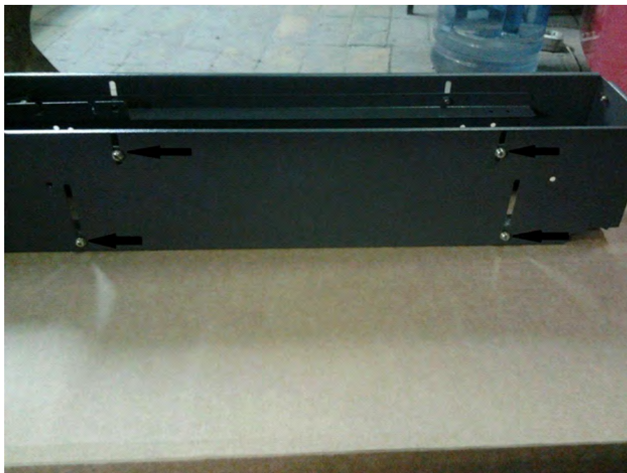
Рисунок 11. Регулировочные винты по глубине товара (правая сторона столбца).
