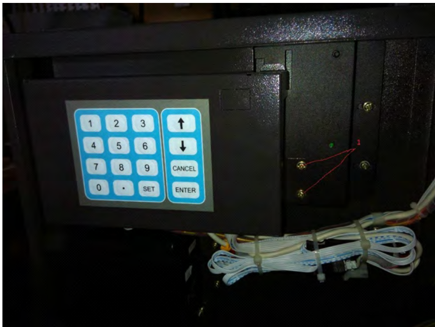
Рисунок 4. Винты крепления крышки блока управления.
