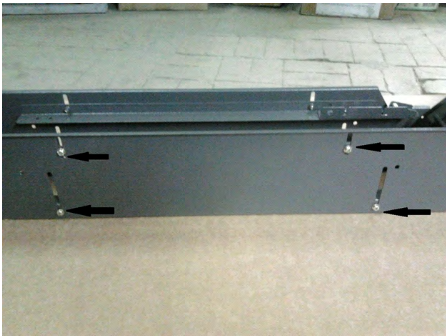
Рисунок 10. Регулировочные винты по глубине товара (левая сторона столбца).
